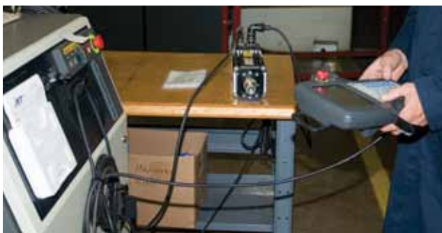
O teste final do sistema garante que o dispositivo de realimentação esteja corretamente alinhado com os polos do motor GSWA.
