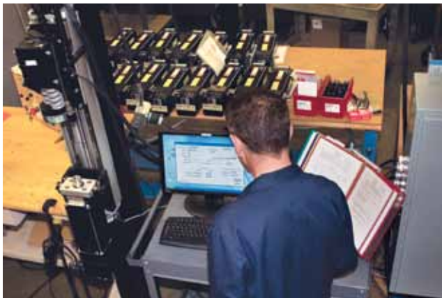
O teste de unidades funcionais por 350 ciclos quantifica o curso, a duração, o torque sem carga, a corrente de entrada vs o desvio padrão de força.
