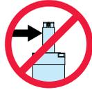
GSWA 일체형 모터 Actuator는 측면 하중이 발생하는 데는 사용하지 않습니다. 측면 하중을 줄이기 위해 가이드와 지지대를 설치해야 합니다. 하중이 추력 Rod의 작동 라인과 일직선을 이루어야 합니다. 측면 하중은 Actuator 수명에 영향을 미칩니다.
