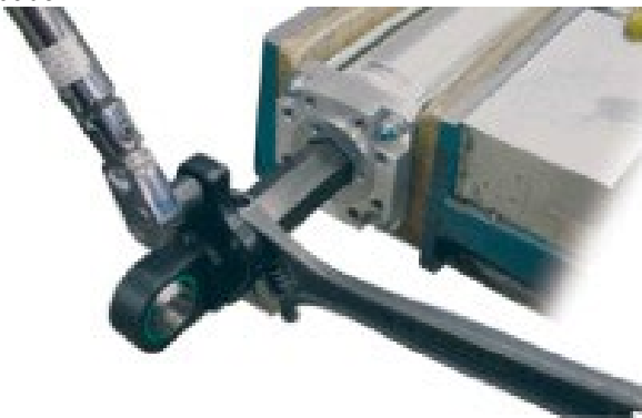
Figura 4.4: (SWA na foto) Para haste hexagonal, mantenha a haste de empuxo estacionária usando uma chave na parte plana da haste ao fixar acessórios, conexões ou carga ao atuador. Use uma chave de torque para apertar a extremidade da haste de interface com o ponto de conexão rosca do atuador. Valores de torque fornecidos na Tabela 4.2
